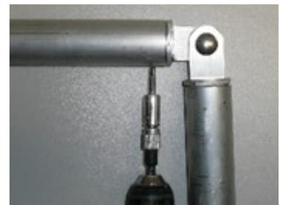
Selbstsichernde Mutter der Schraube des Eckverbinders fest verschrauben.
