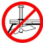
Die Enden der Trapezbleche sind in jeden Untergurt oder in jeden Obergurt zzgl. Kalotten zu verschrauben.
