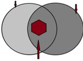
Bei Überschneidung der Bohrlöcher müssen min. 10 mm Luft bleiben für die M 8 x 70.
